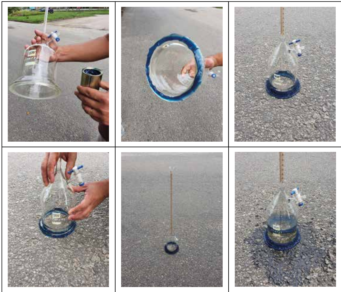
Figura 9.37 – Ensaio de drenabilidade com drenômetro de vidro com outra geometria – passos do ensaio (preparação do equipamento e realização do ensaio) (Fotos Marcos Fritzen, 2021)
