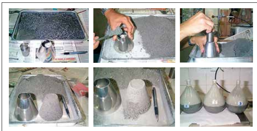
Figura 3.24 – Esquema do ensaio de massa específica de agregados miúdos considerando a absorção
