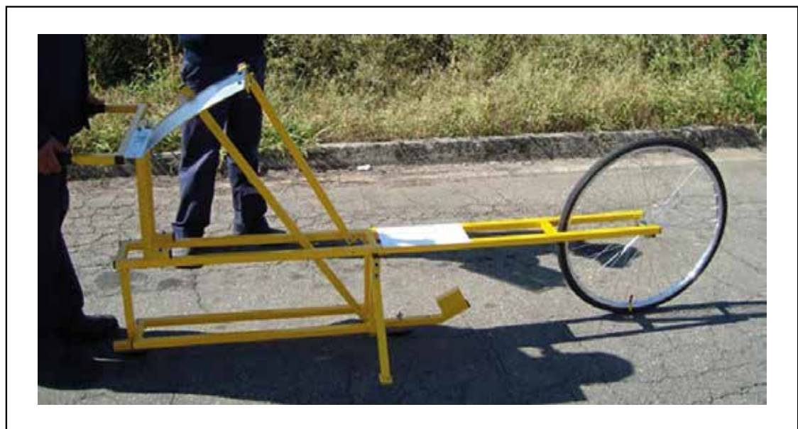
Figura 9.14 – Exemplo de equipamentos Merlin medidor de irregularidade
