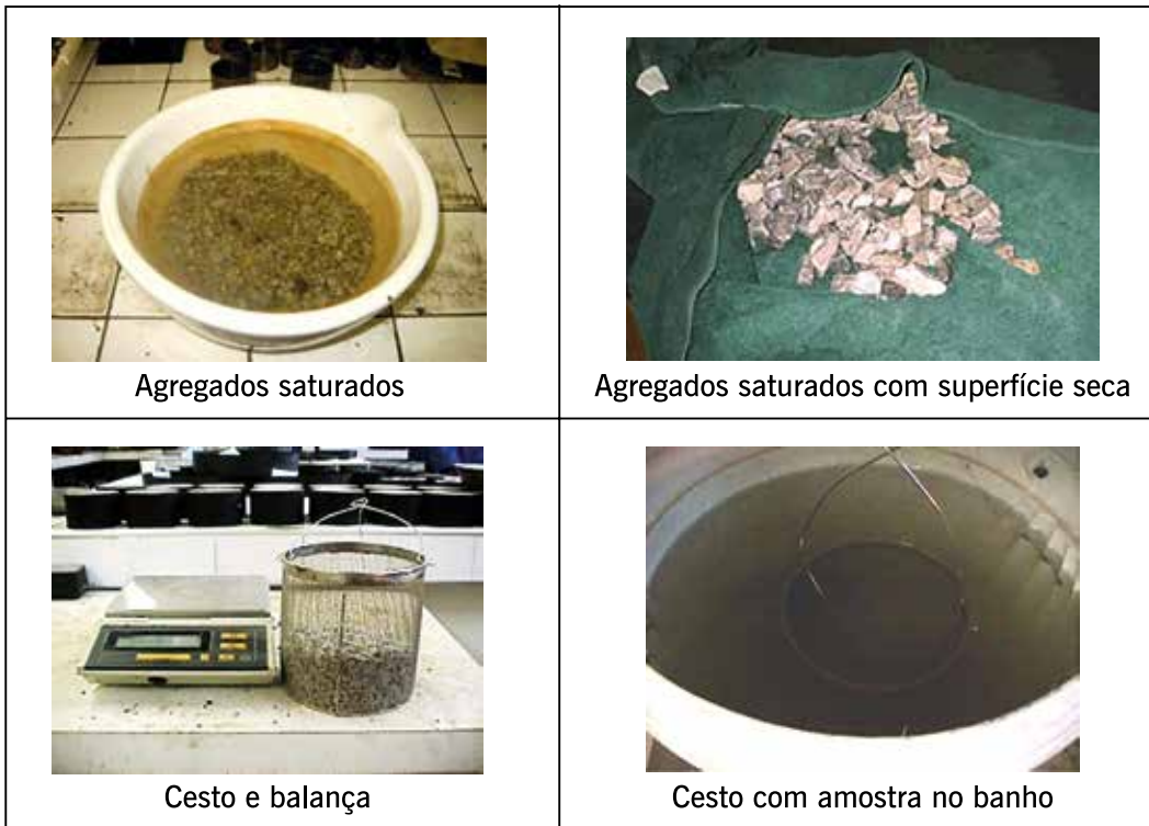
Figura 3.22 – Aspectos da determinação de massas no método DNIT 4113/2019
