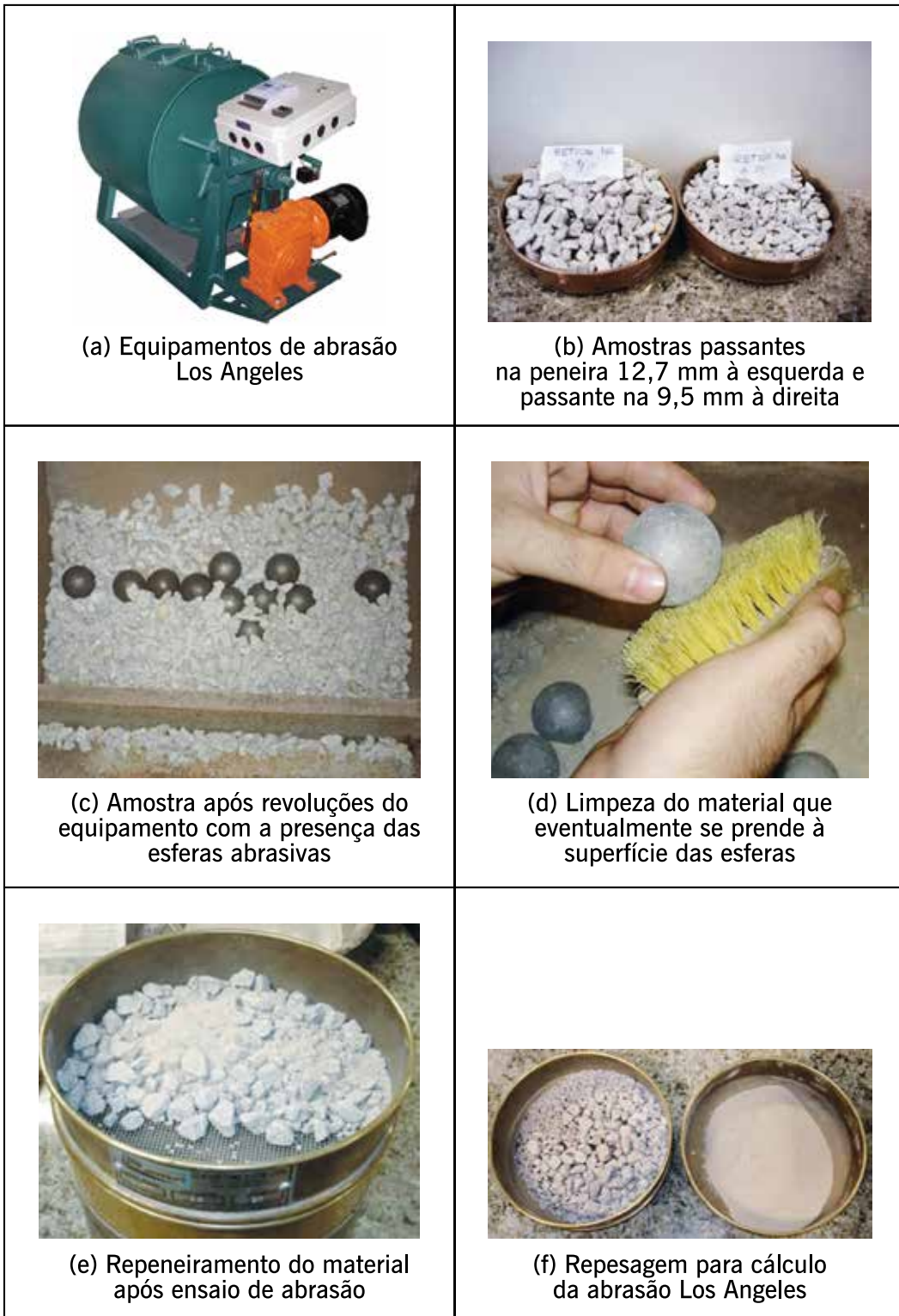
Figura 3.11 – Equipamento para ensaio de abrasão Los Angeles e etapas do ensaio
