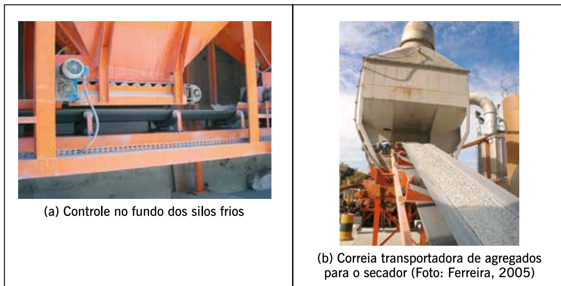
Figura 8.8 – Exemplo de controle de alimentação de agregados de um silo frio e correia transportadora de agregados para o secador
