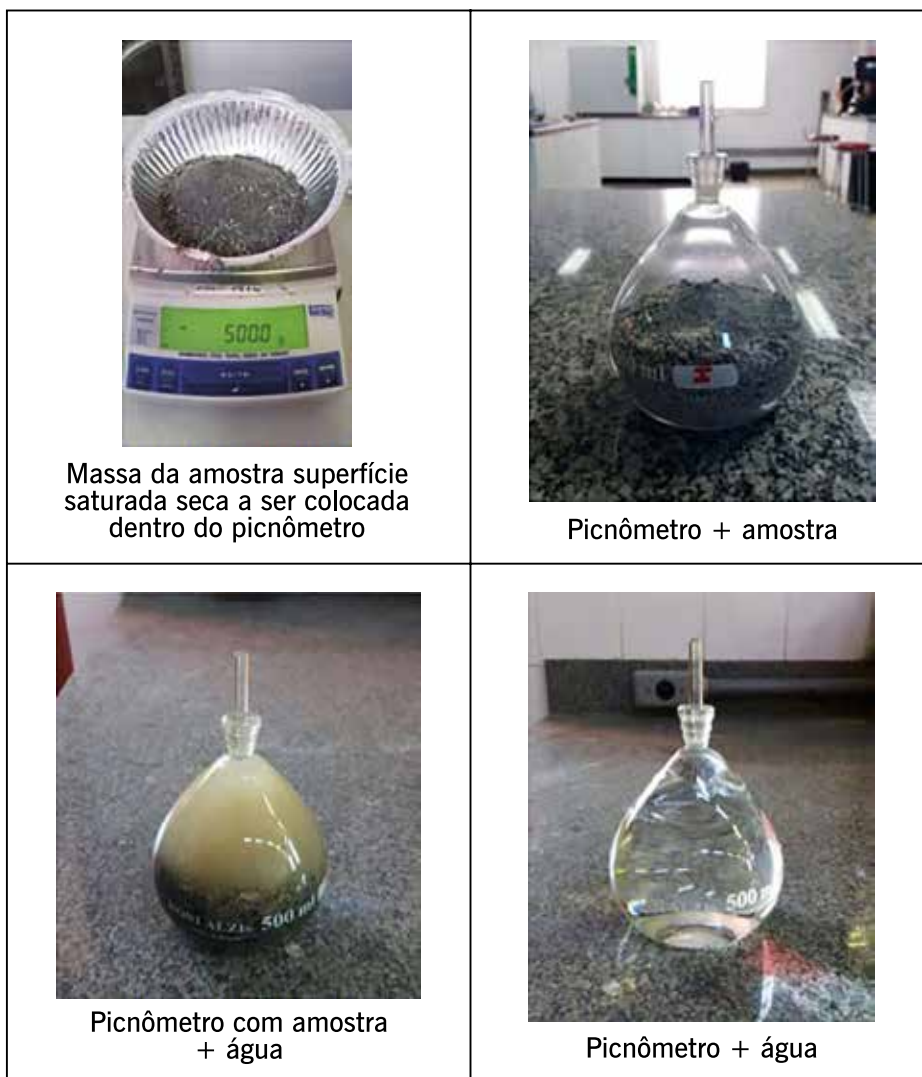
Figura 3.23 – Esquema do ensaio de massa específica de agregados miúdos
