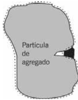
Figura 3.21 – Esquema da partícula de agregado na determinação da G_{se}
