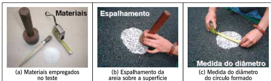
Figura 9.33 – Equipamentos e passos do ensaio de mancha de areia (Fotos: Marcia Aps)
