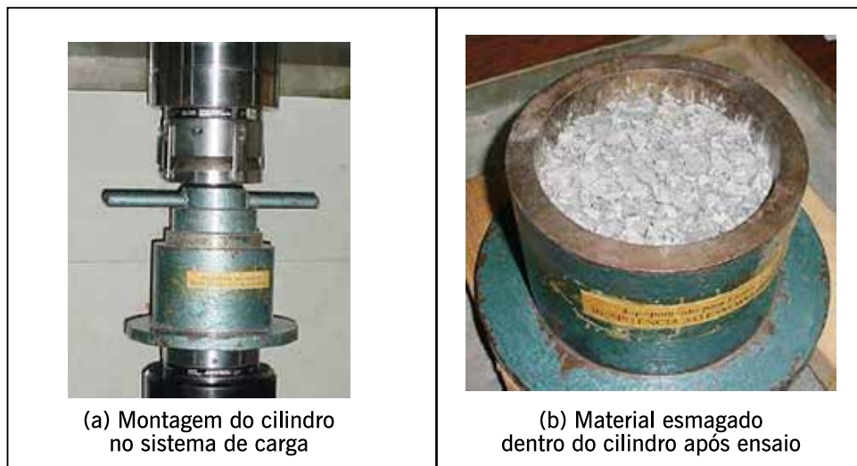
Figura 3.14 – Conjunto de cilindro e êmbolo utilizado nos ensaios de 10% de finos (DNER-ME 96/98) e resistência ao esmagamento (DNER-ME 197/97)
