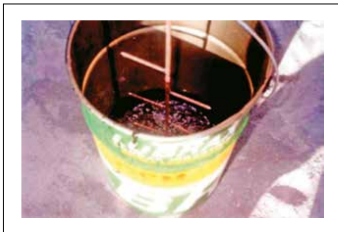
Figura 2.65 – Exemplo de esquema de avaliação da taxa de expansão da meia-vida de um asfalto espuma em campo
