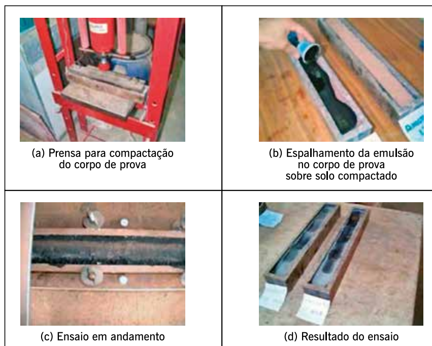
Figura 4.26 – Ensaio de desgaste LWT modificado para antipó
