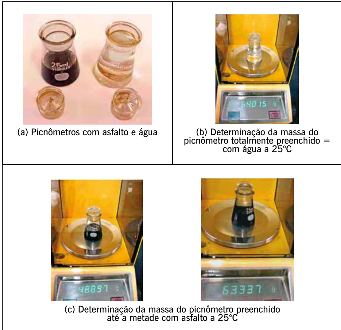
Figura 2.21 – Etapas do ensaio de massa específica do ligante
