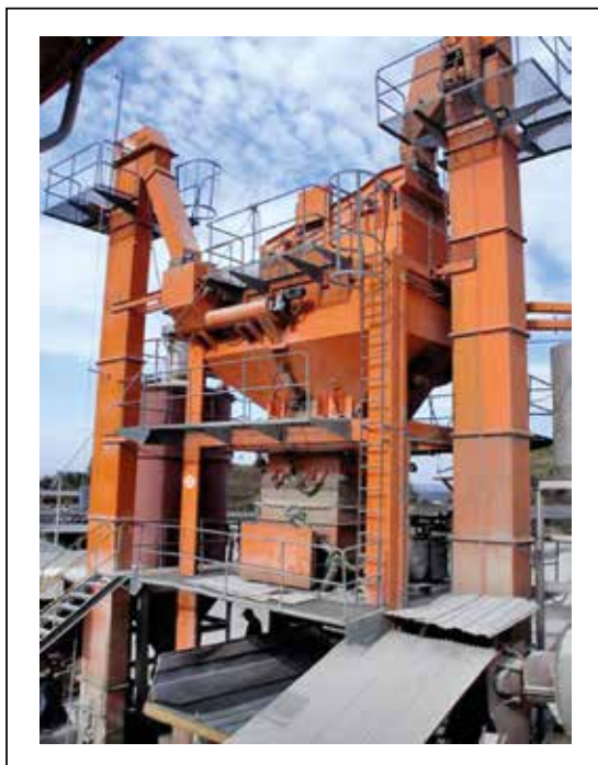
Figura 8.15 – Exemplo de um elevador de agregados aquecidos e silos quentes (Foto: Abdou)
