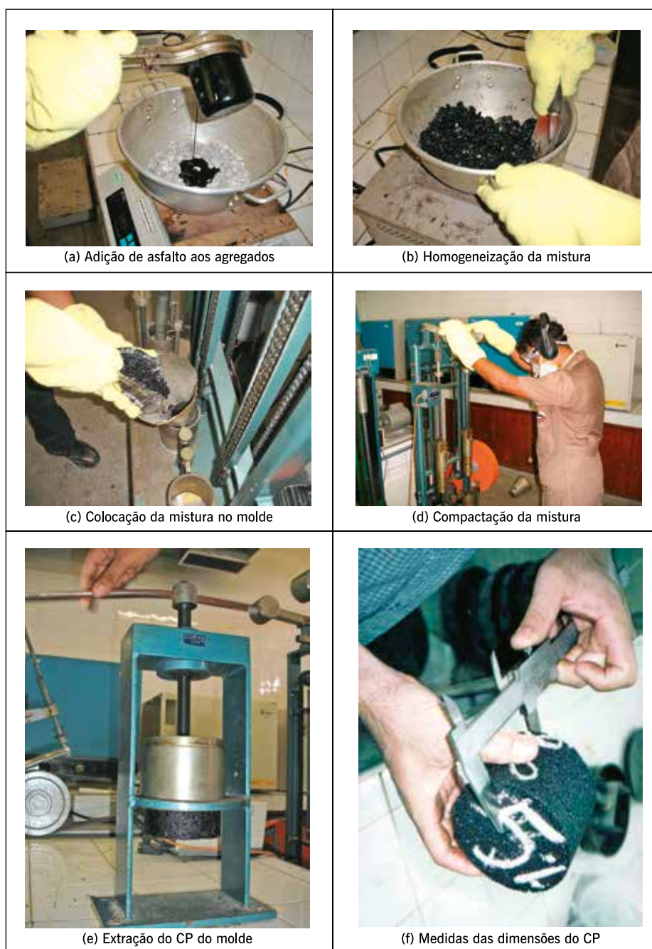
Figura 5.13 – Moldagem de CPs tipo Marshall em laboratório
