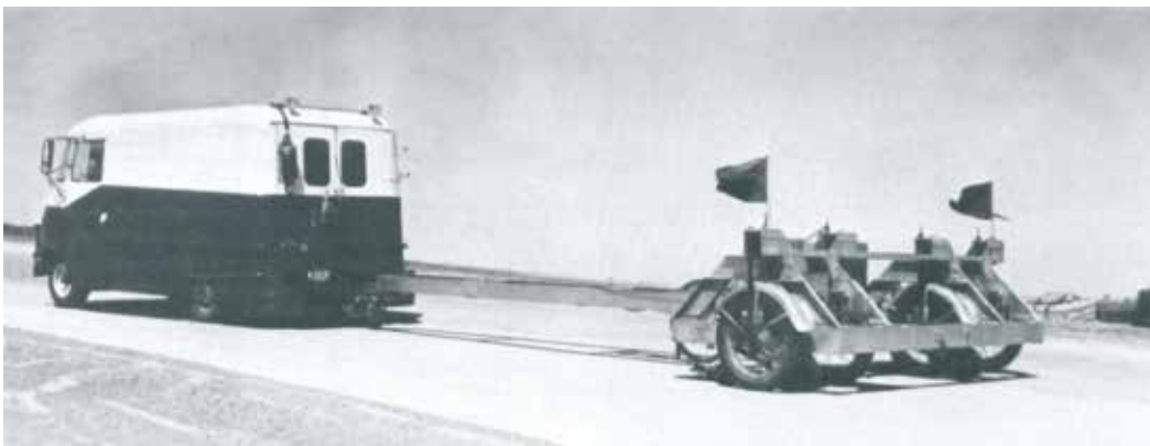
(a) Perfilômetro empregado nas pistas experimentais da AASHO
