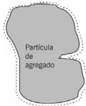
Figura 3.19 – Esquema da partícula de agregado na determinação da G_{sa}
