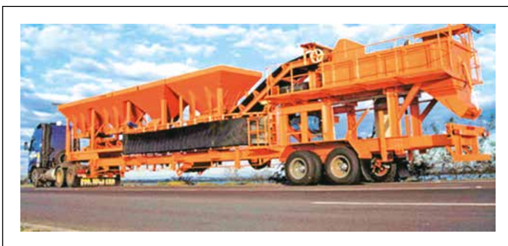
Figura 8.20 – Exemplo de usina de pré-misturado a frio móvel
