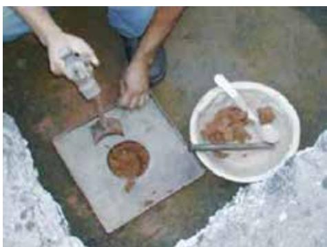
(e) Abertura de orifício em camada de solo dentro do poço de sondagem (Foto Preusler, 2007)
