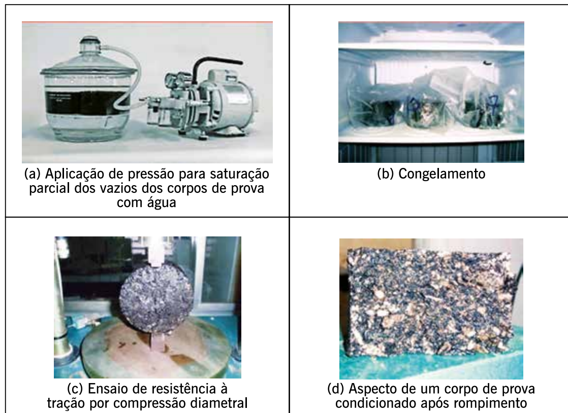
Figura 5.26 – Passos para o condicionamento acelerado e para a determinação da RT para o ensaio de DUI de misturas asfálticas compactadas
