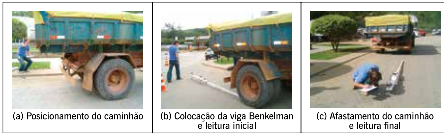
Figura 10.7 – Etapas do ensaio com a viga Benkelman convencional
