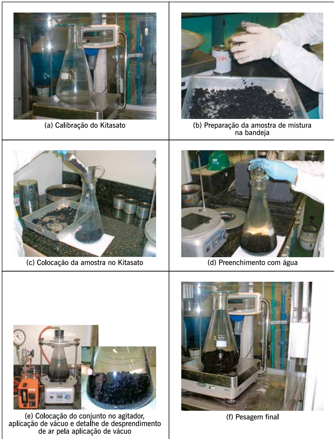
Figura 5.6 – Exemplo de procedimento para determinação da Gmm em laboratório (fotos: Marques, 2004)
