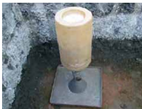
(f) Funil de areia para controle de massa específica in situ (Foto Preusler, 2007)
