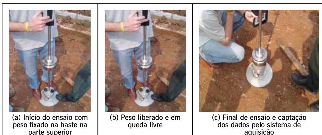
Figura 10.4 – LWD (Light Weight Deflectometer) equipamento de avaliação expedita do módulo elástico de camadas de pavimento (Fotos Dynatest)
