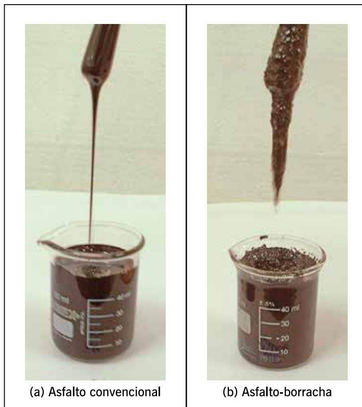
Figura 2.47 – Exemplo de maior consistência do asfalto-borracha no momento da usinagem
