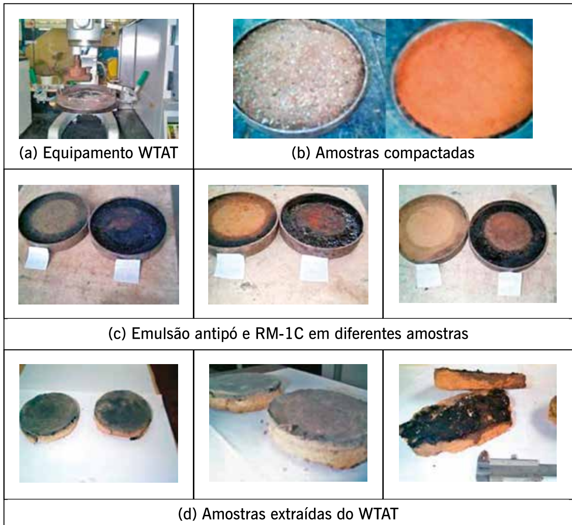
Figura 4.27 – Ensaio de desgaste WTAT modificado para antipó
