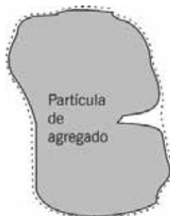
Figura 3.20 – Esquema da partícula de agregado na determinação da G_{sb}
