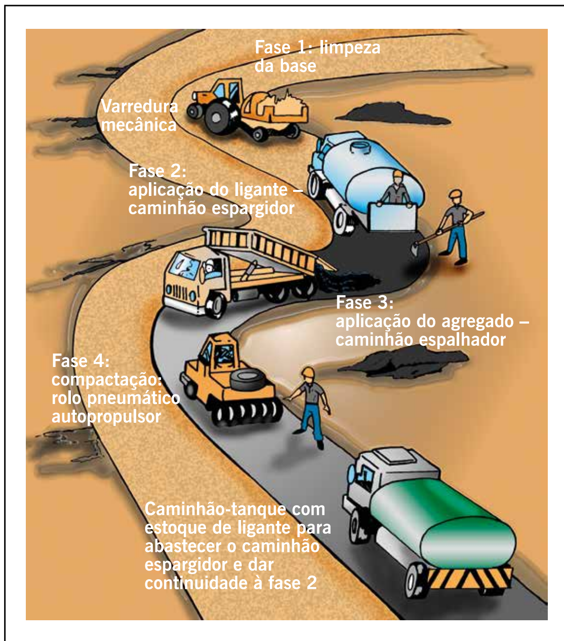
Figura 8.40 – Sequência esquemática de construção de um tratamento superficial
