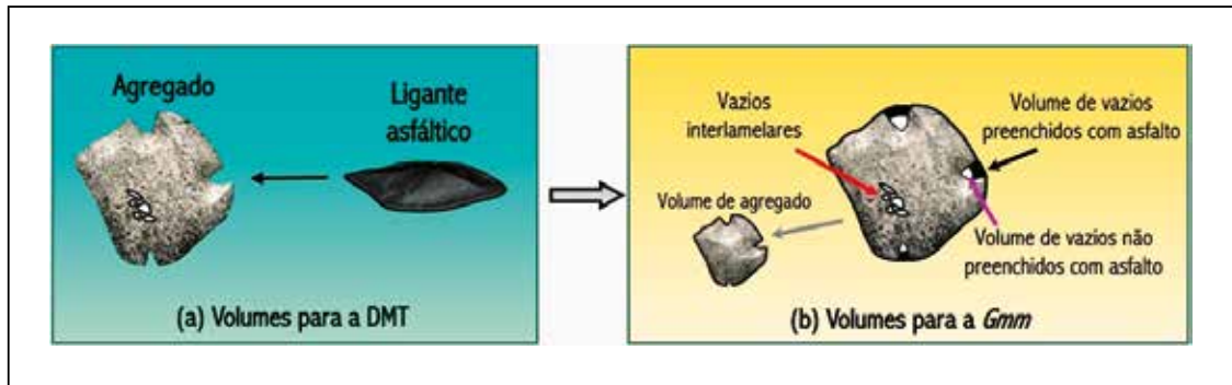
Figura 5.5 – Ilustração dos volumes considerados na determinação da DMT e da Gmm
