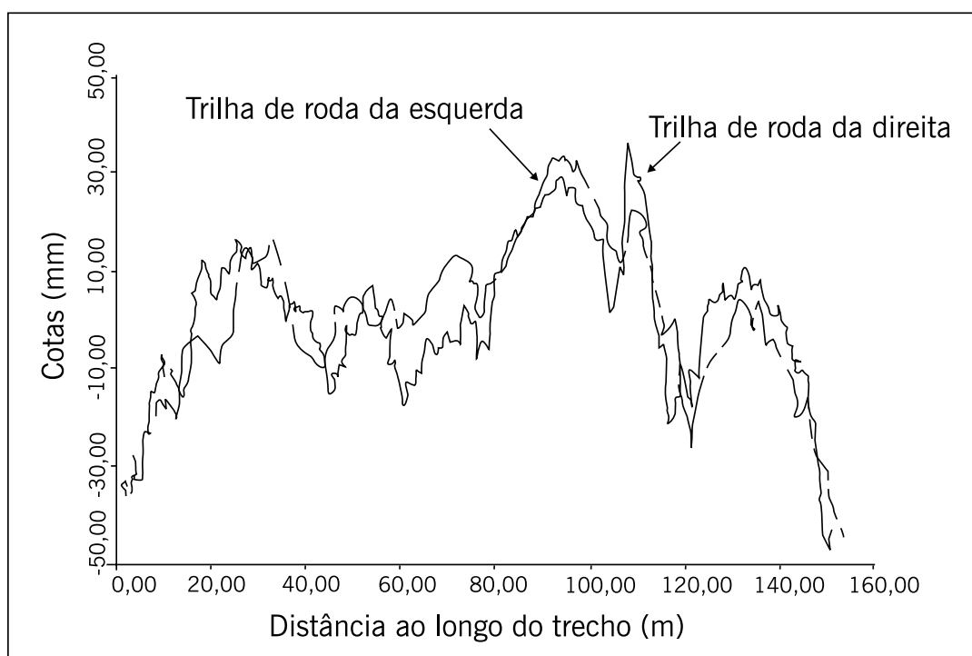
Figura 9.9 – Exemplo de levantamento da irregularidade longitudinal por nível e mira
