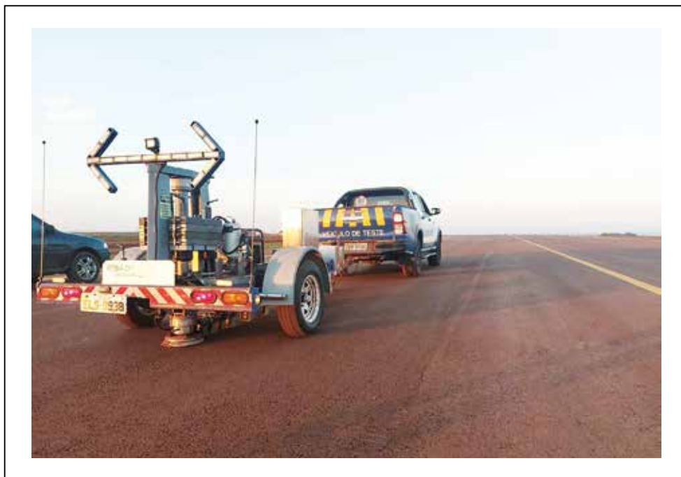
Figura 10.21 – Exemplo de medida de deflexão com FWD em aeroportos
