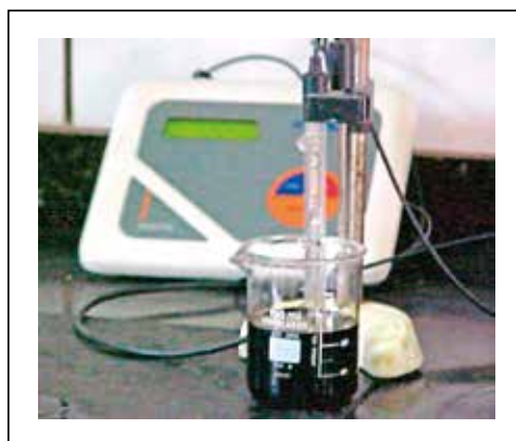
Figura 2.63 – Determinação do pH da emulsão
