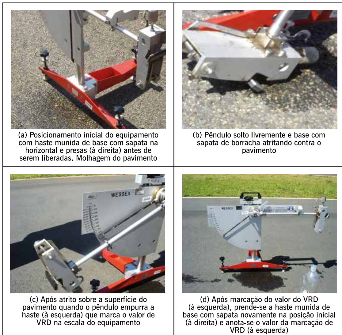
Figura 9.32 – Operação do equipamento pêndulo britânico para a determinação do valor de resistência à derrapagem (Fotos: Callai e Vieira)
