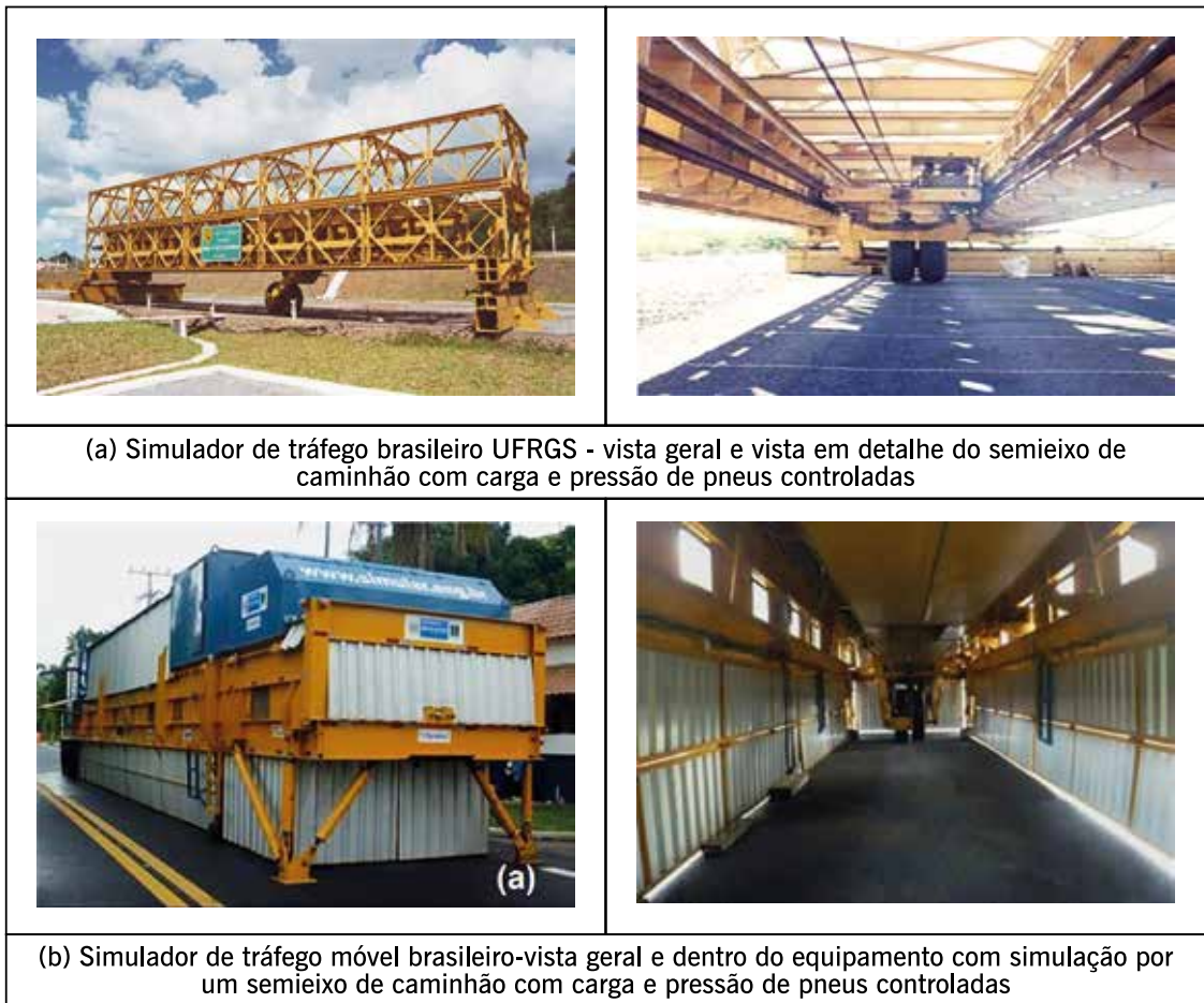
Figura 6.48 – Simuladores brasileiros em verdadeira grandeza para uso em campo de provas de pavimentos e móveis para testagem de pavimentos rodoviários
