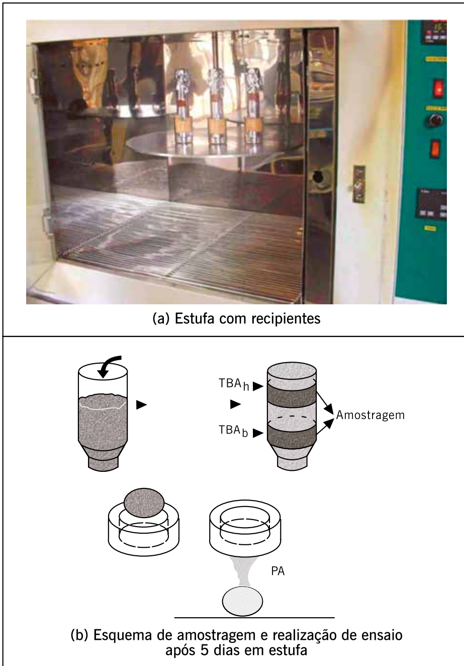
Figura 2.42 – Ensaio de separação de fases ou estabilidade ao armazenamento de asfalto-polímero (a) recipientes padrão colocados dentro da estufa e (b) desenho esquemático da amostragem de ligante armazenado dentro do recipiente e ensaio
