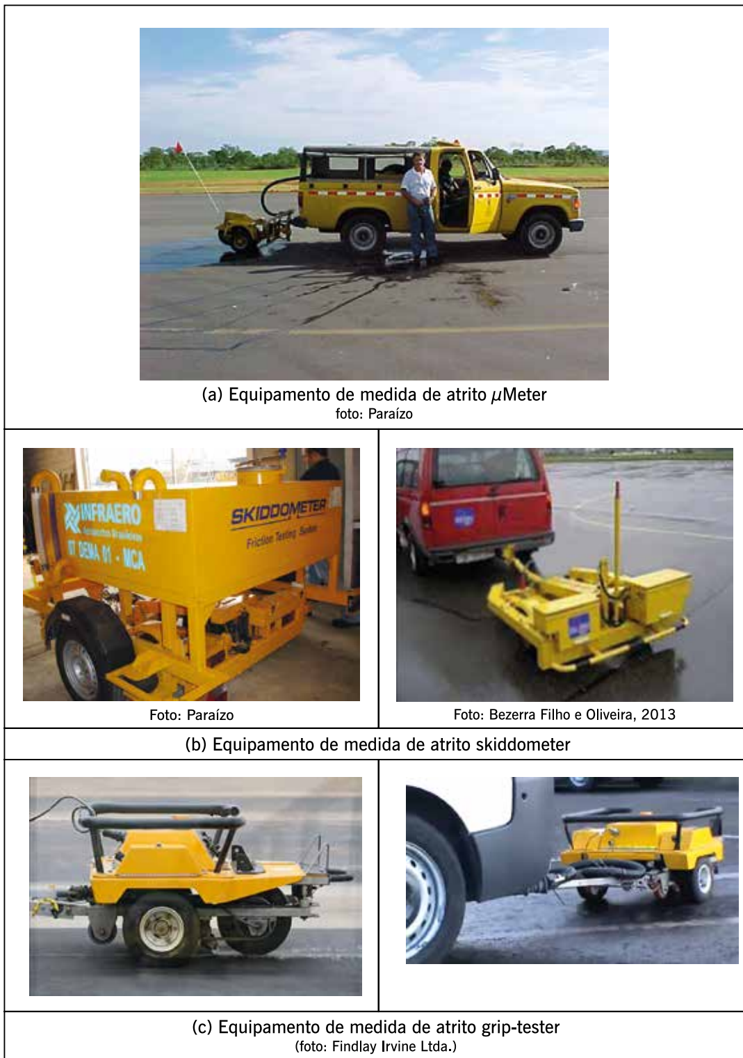
Figura 9.38 – Exemplos de equipamento de medida de atrito em pavimentos
