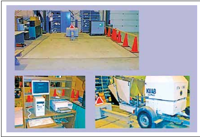
Figura 10.19 – Exemplo de modelo de centro de calibração de FWD (Fotos: Centro Regional de Calibração do Norte dos EUA)
