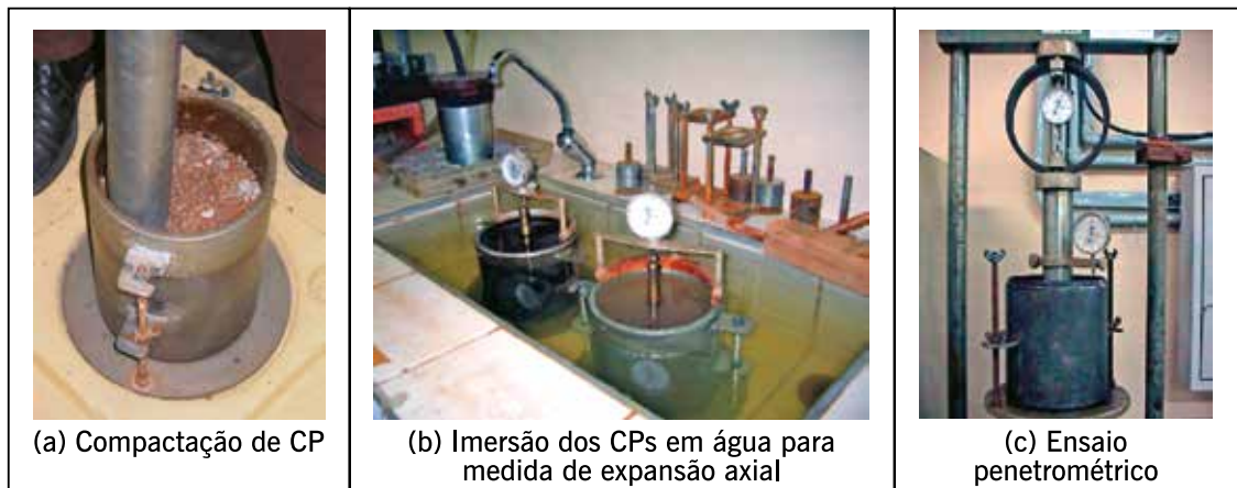
Figura 7.4 – Etapas do ensaio ISC
