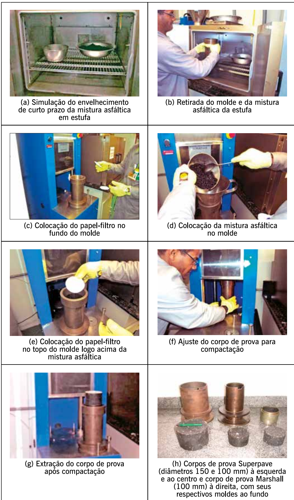
Figura 5.22 – Sequência do procedimento de compactação Superpave
