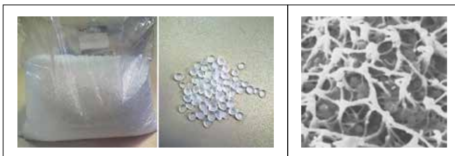
Figura 2.40 – Aparência do polímero RET e de sua mistura com o cimento asfáltico
