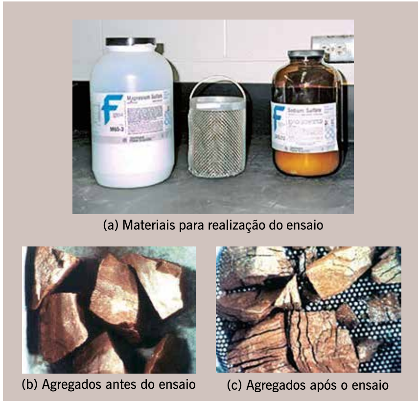
Figura 3.18 – Exemplo de materiais utilizados no ensaio de sanidade e resultado
