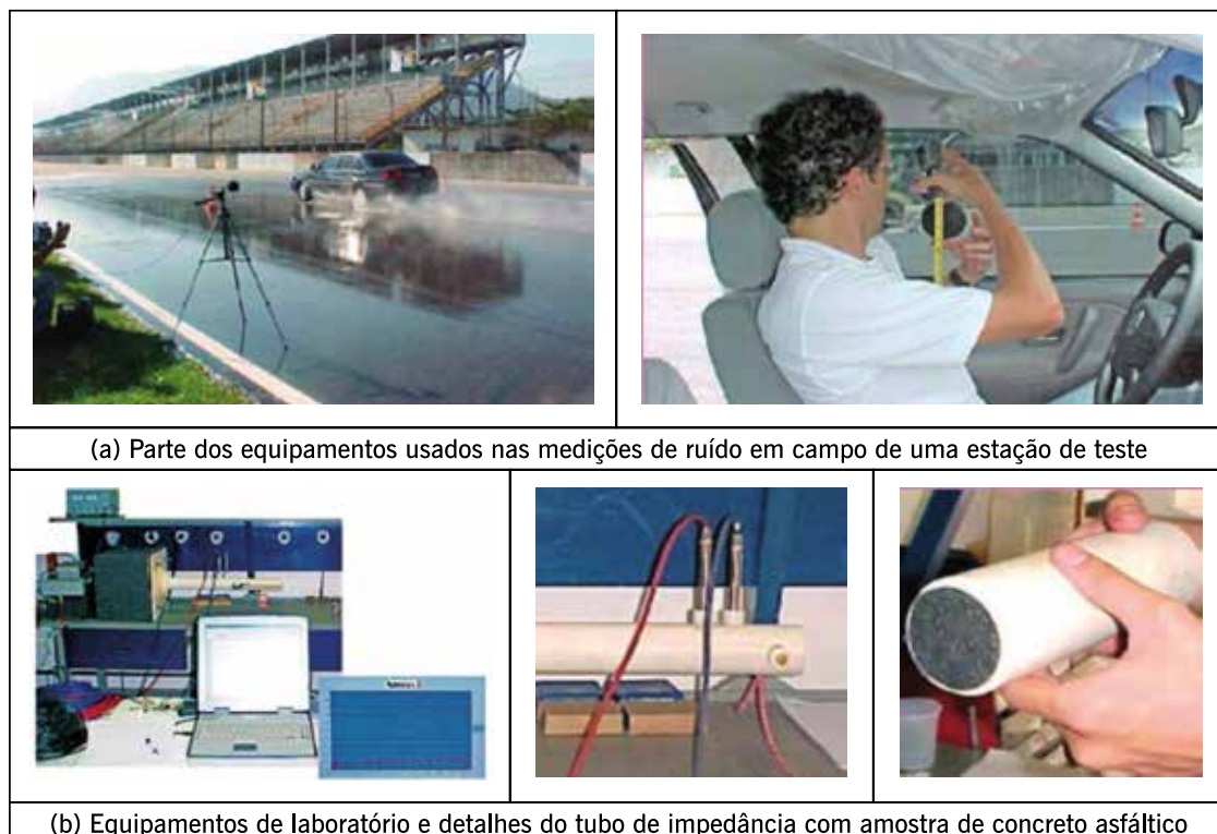
Figura 9.40 – Exemplo de arranjos de conjunto de equipamentos para medições de ruído gerado com a contribuição do pavimento (foto: Láo, 2004)
