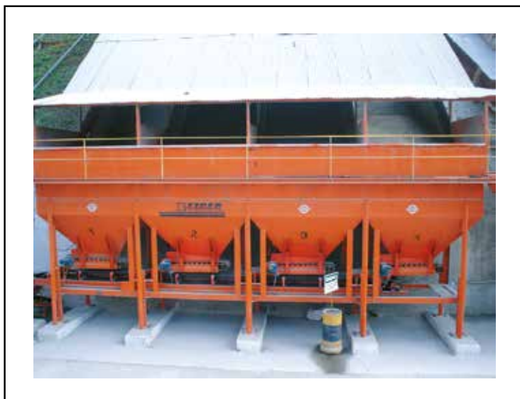
Figura 8.5 – Exemplo de estoques e silos cobertos para proteção dos materiais de uma usina gravimétrica
