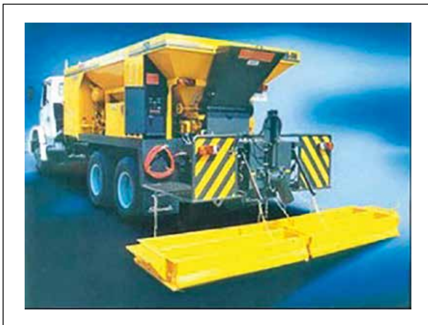
Figura 8.42 – Exemplo de equipamento para produção e aplicação de lama asfáltica (foto: Romanelli S.A.)
