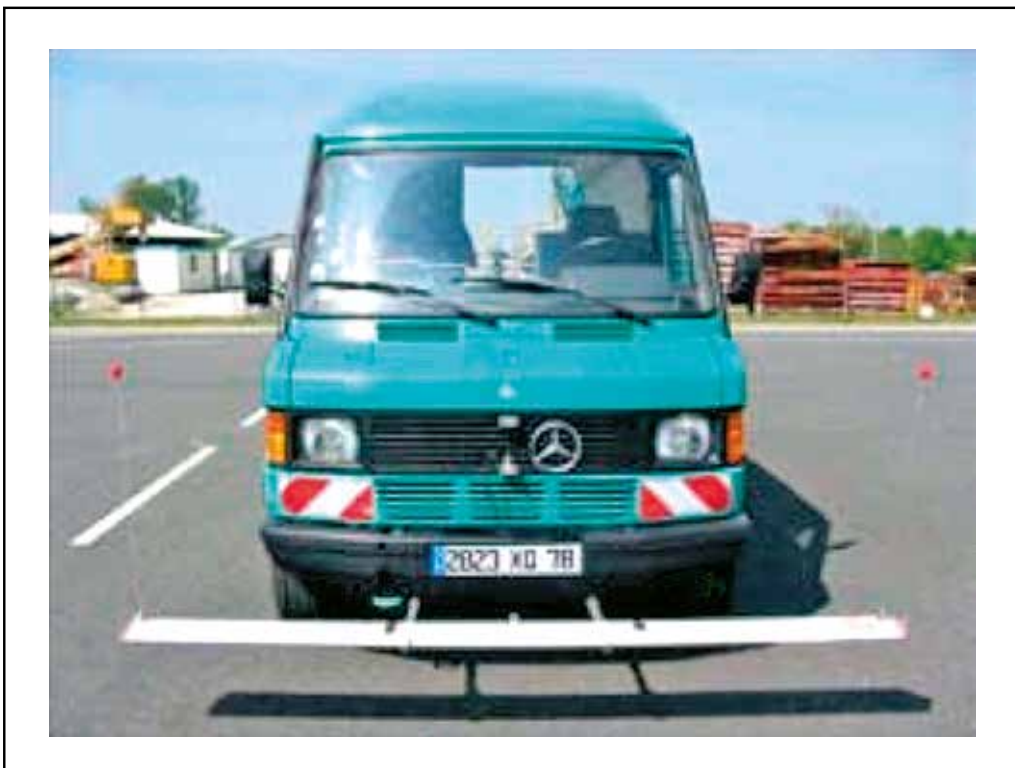
Figura 9.12 – Exemplo de equipamento munido de barra com ultrassom
