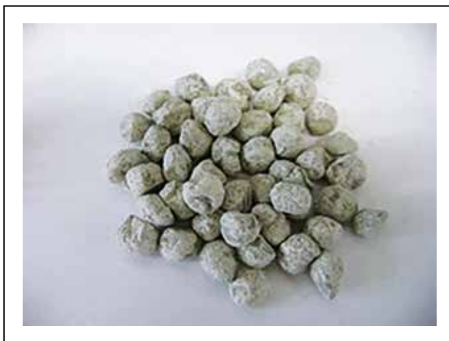
Figura 2.51 – Ligante asfáltico TLA em forma de grãos peletizados
