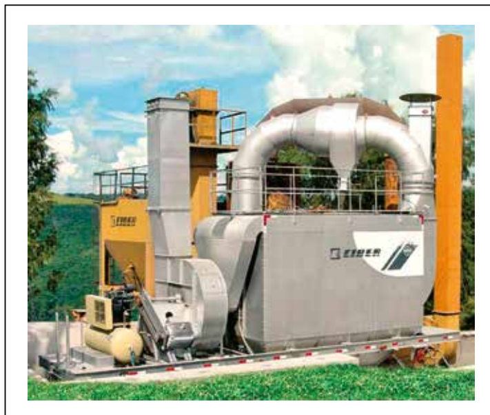
Figura 8.13 – Exemplo de sistema de coletores de pó (Foto: Ciber Ltda.)
