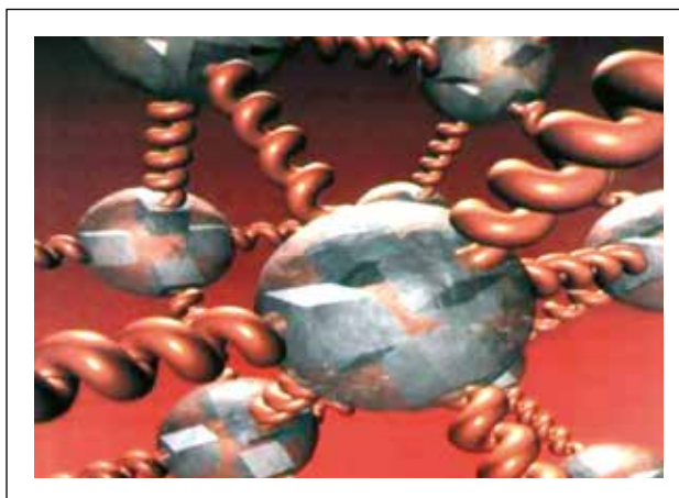
Figura 2.37 – Representação esquemática da estrutura de um elastômero termoplástico à temperatura ambiente
